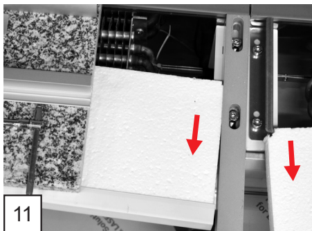
11 Zdjęcie izolacji pod blatem roboczym
